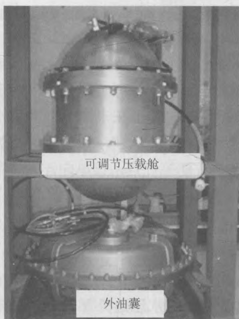
图 4.21 日本“URASHIMA” AUVs 浮力调节系统 [13]
