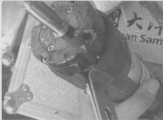
图 3.28 铝合金壳体点蚀
