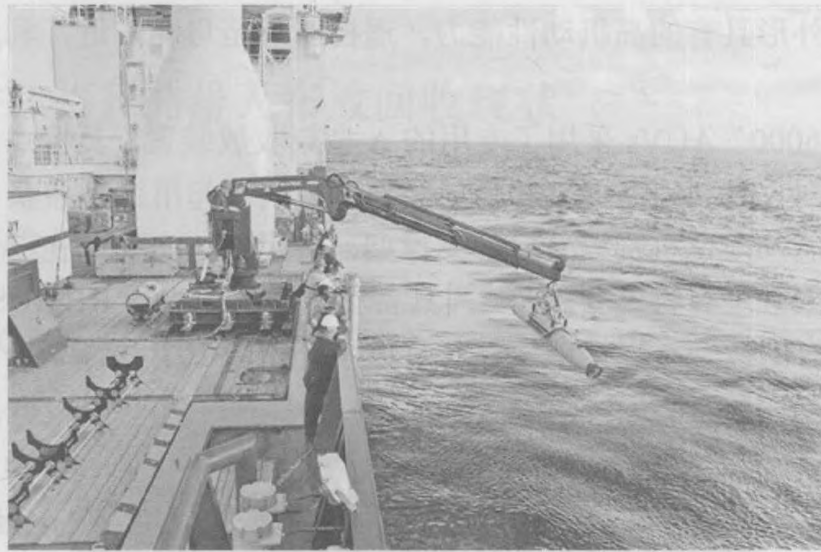
图 10.3 “Bluefin-21” AUVs 收放系统 [7]
