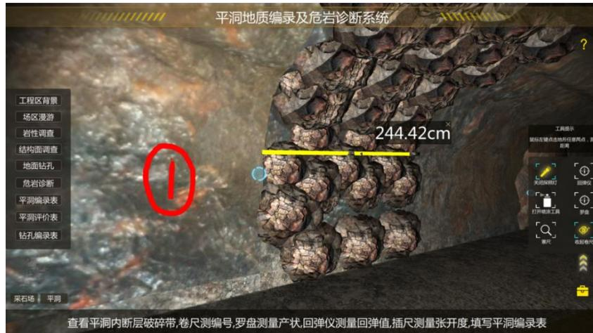
图 8 喷涂工具和卷尺使用界面
