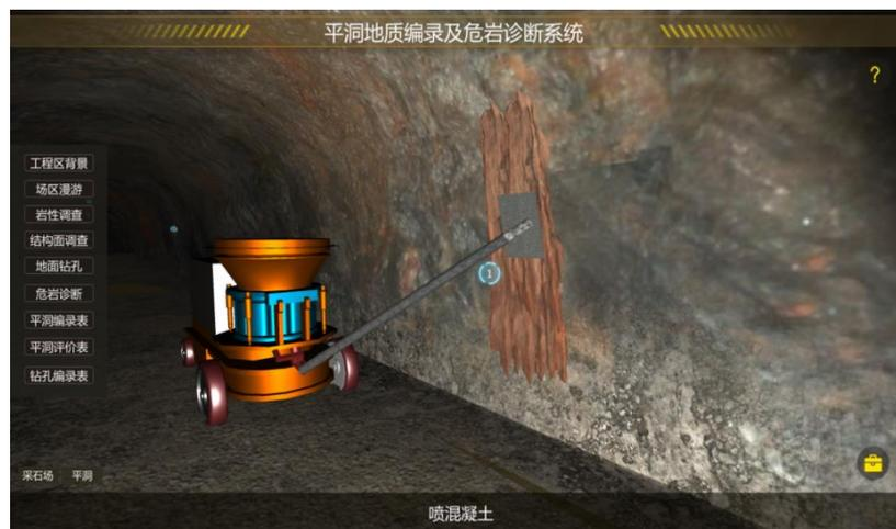
图 20 混凝土喷护模拟界面
