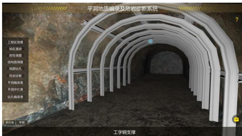
图 19 工字钢支撑模拟界面
