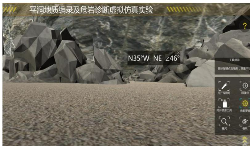
图 5 采石场岩性调查界面（抵近后进行结构面量测）
